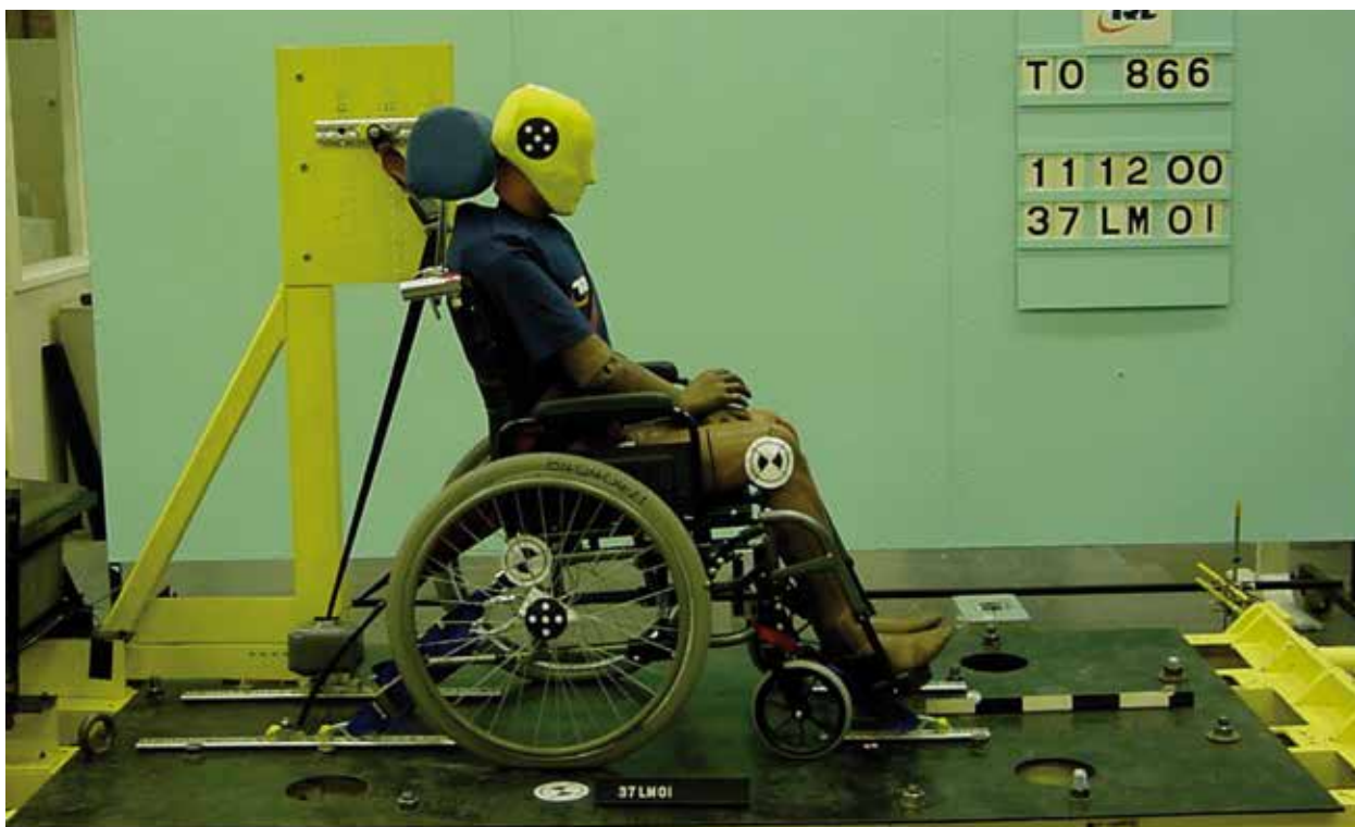
Rullstol säkrad på skenorna, före kollision
