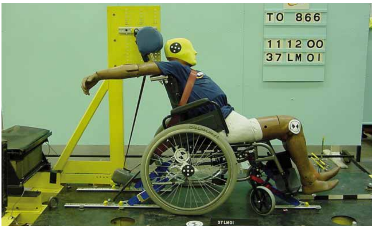
Rullstol säkrad på skenorna, efter kollision
