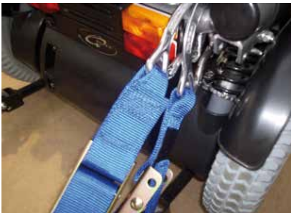
Bakre fästpunkt på rullstolen Viktigt! två band på vardera sida!
