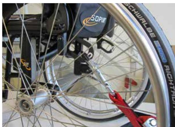
Punto di ancoraggio posteriore della carrozzina
