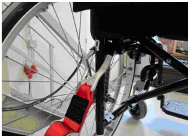
Punto di ancoraggio posteriore della carrozzina
