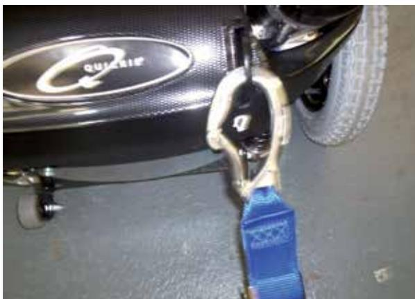
Punto di ancoraggio posteriore della carrozzina
