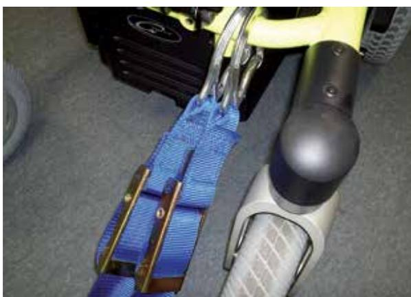
Punto di ancoraggio posteriore della carrozzina
