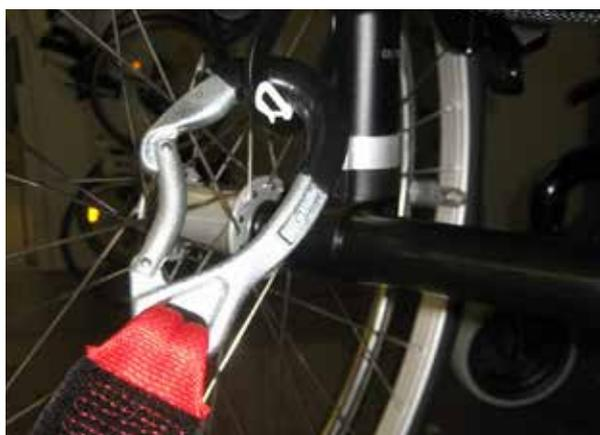
Punto di ancoraggio posteriore della carrozzina
