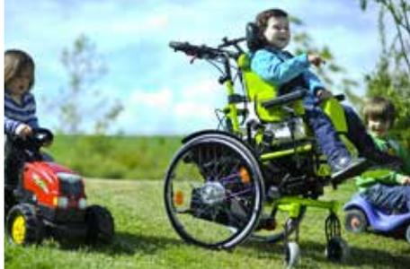
Carrozze Sunrise Medical sottoposte a test conforme allo standard USA ANSI/RESNA WC 19 (armonizzato con lo standard ISO 7176-19)\*:
