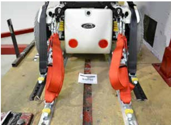
Punto di ancoraggio posteriore della carrozzina
