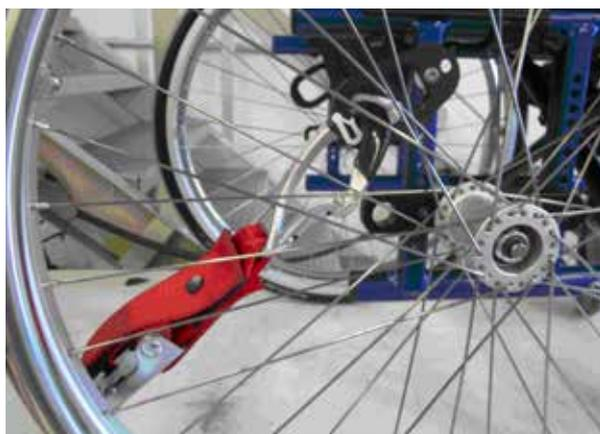
Punto di ancoraggio posteriore della carrozzina
