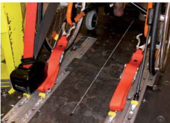
Punto di ancoraggio posteriore della carrozzina
