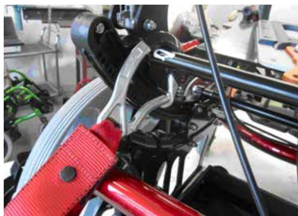
Punto di ancoraggio posteriore della carrozzina
