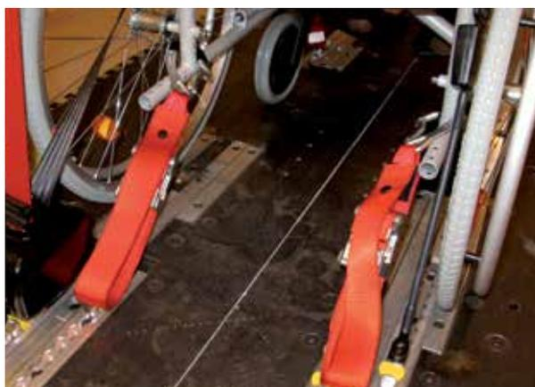
Punto di ancoraggio posteriore della carrozzina
