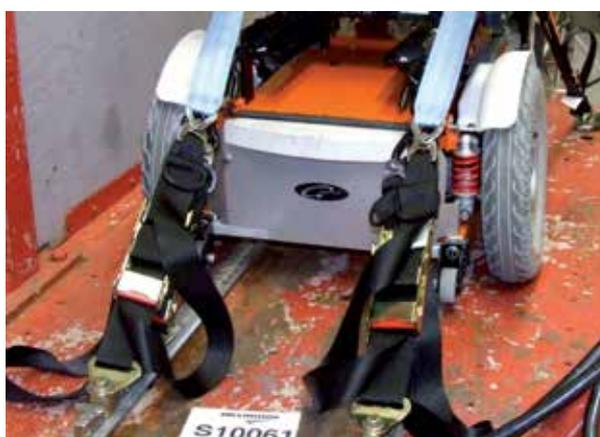
Punto di ancoraggio posteriore della carrozzina
