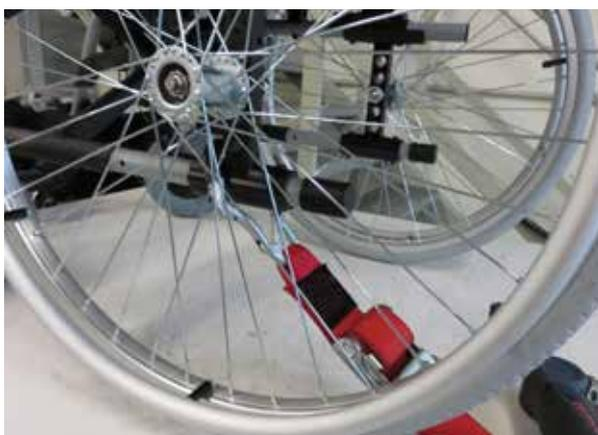
Punto di ancoraggio posteriore della carrozzina
