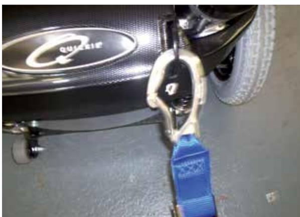
Punto di ancoraggio posteriore della carrozzina
