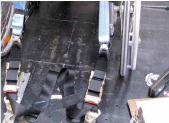
Punto di ancoraggio posteriore della carrozzina
