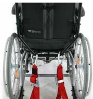
Punto di ancoraggio posteriore della carrozzina
