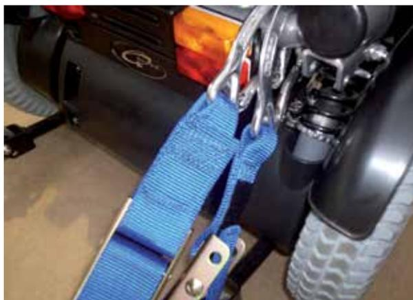
Punto di ancoraggio posteriore della carrozzina
