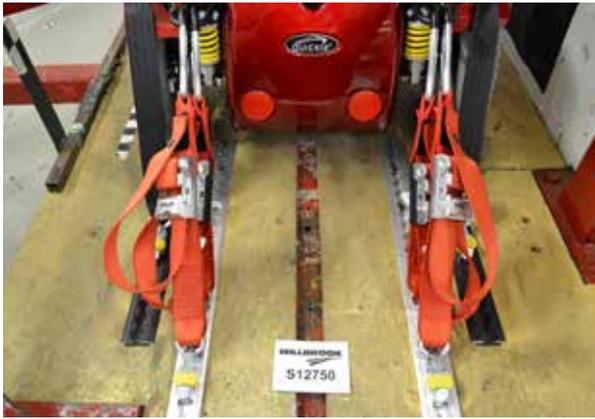
Punto di ancoraggio posteriore della carrozzina
