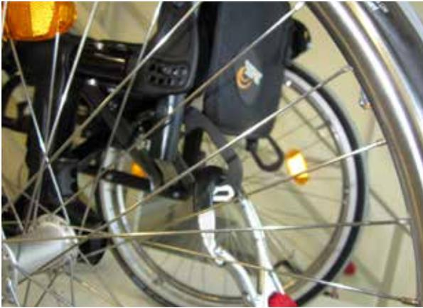
Punto di ancoraggio posteriore della carrozzina
