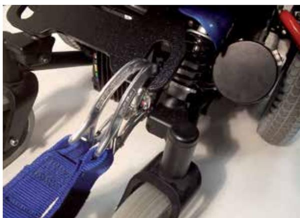
Punto di ancoraggio posteriore della carrozzina
