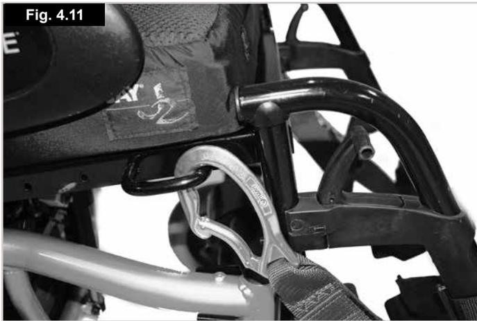
Positionnement du système d'arrimage avant, (Fig. 4.11).
