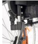
LFE030012 Schienale regolabile in angolazione da -12° a 12°
