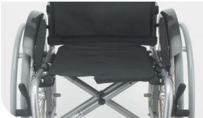
Con este novedoso diseño de la estructura de la silla, los tubos del asiento y la cruceta, quedan por dentro de los del armazón, al mismo nivel. De esta forma el armazón bloquea el movimiento de los tubos del asiento y así se aumenta la rigidez de la silla, se facilita su propulsión y se equipara su estética a la de las sillas de armazón rígido.
