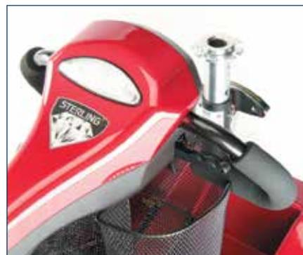
Sistema di smontaggio Sterling<sup>®</sup> del sedile, veloce e senza fili o connessioni
